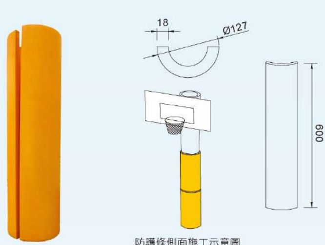
防護條側面施工示意圖
